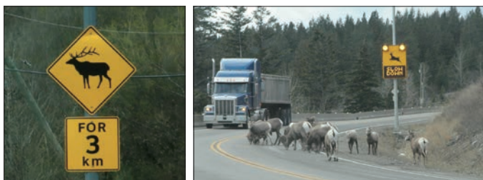
図5 警戒区間を表示した標識（左）とセンサーで感知し点滅する警告標識 6) （右）
