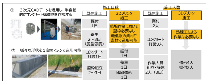
図5 建設用3Dプリンタによる施工性の向上 5)
