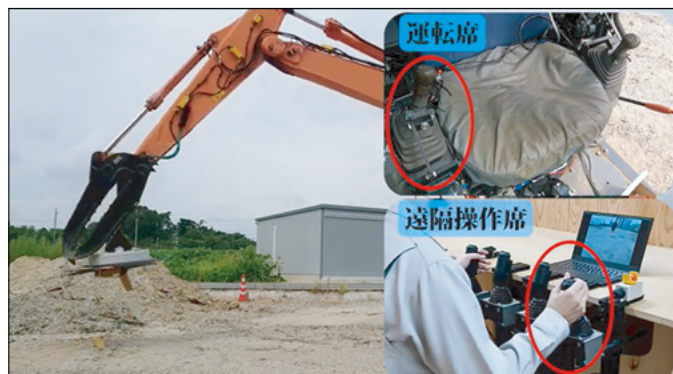
図6 遠隔操作システム Model Vの使用状況 6)
