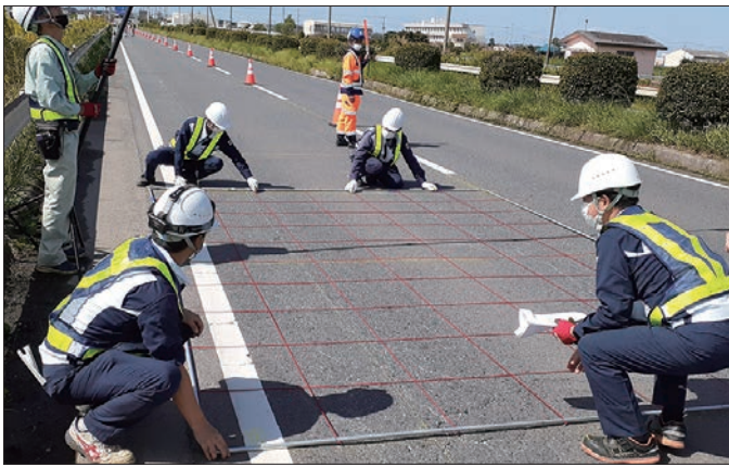
写真1 舗装点検の正解値測定状況例（ひび割れ率の測定）
