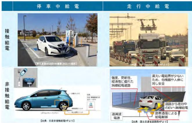
図6 自動車への給電方法の体系
