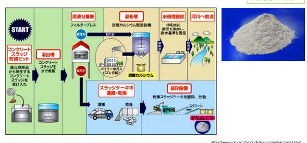
図 20 混和材製造時の CO<sub>2</sub> 利用 (その 2)
