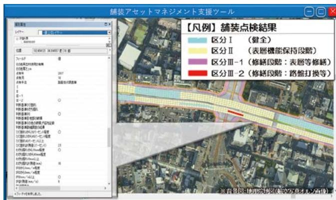
図 3 道路基盤地図情報上への道路舗装 DB データの重畳<sup>3)</sup>
