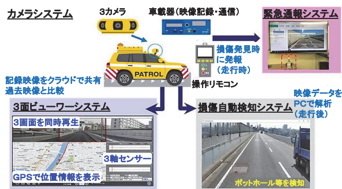
図4 車載カメラ映像共有化システムのイメージ 1)
