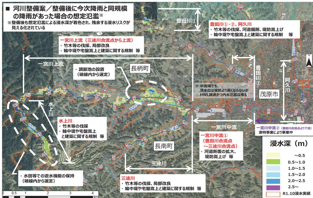
図 2 河川整備の概要と整備後の残余リスク（浸水対策案<sup>2)</sup> 図を加筆・修正）
