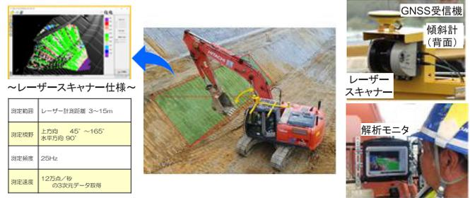
図-3 重機搭載型出来形計測システム<sup>1)</sup>
