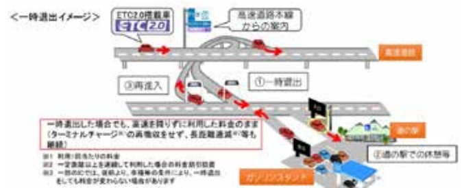
図 2-3 高速道路からの一時退社会実験概要 (出典：国土交通省資料)
