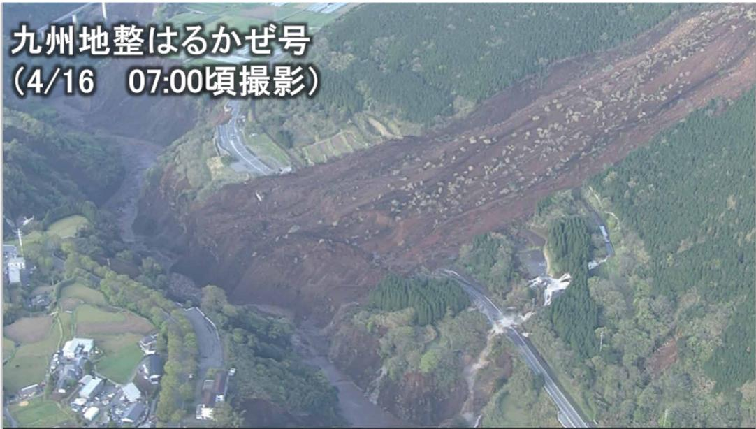
図-1 阿蘇大橋地区斜面崩壊 (国道57号寸断、阿蘇大橋落橋)
