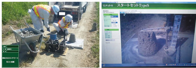
現場側 撮影の状況(生コン性状試験) 監督側 モニターの状況(スランプ確認)
