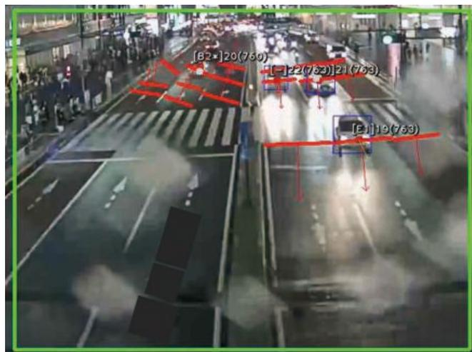
図-7 夜間・降雨時の AI 技術による交通量計測の実際
