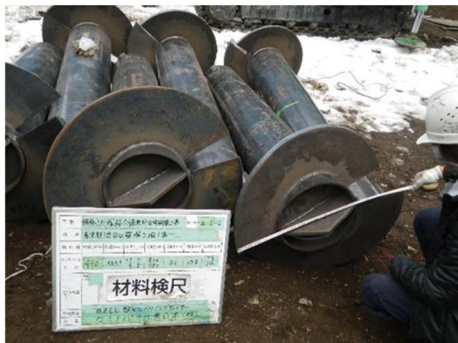
写真-1 杭先端部の拡翼
