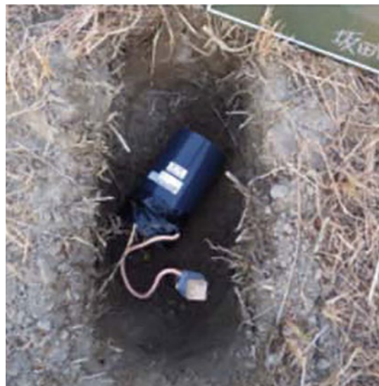
写真 4-2 侵食センサの設置状況
