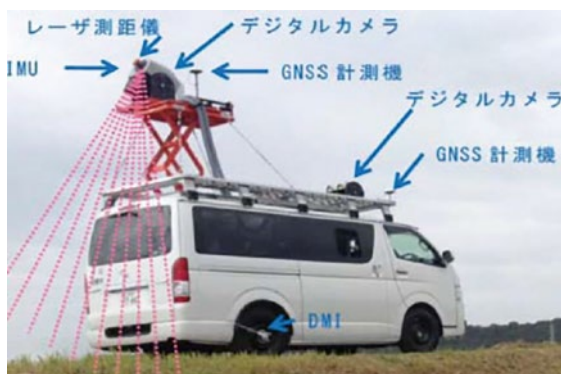
図 4-3 MMS による堤防での計測イメージ 3)
