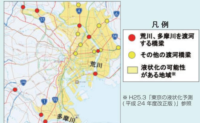
図 2-1 液状化により橋梁段差の発生が懸念される渡河橋梁
