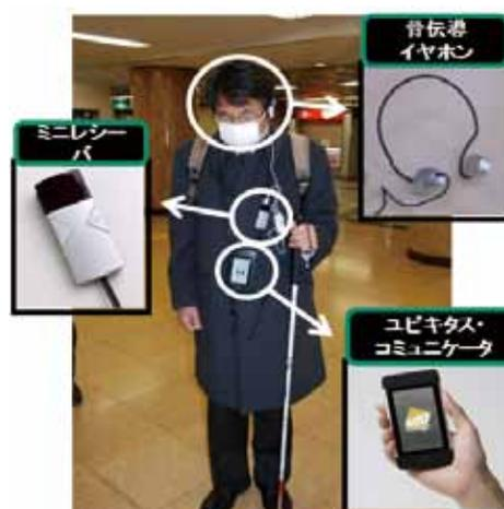
図 1-3 視覚障害者移動支援実験の使用機器類
