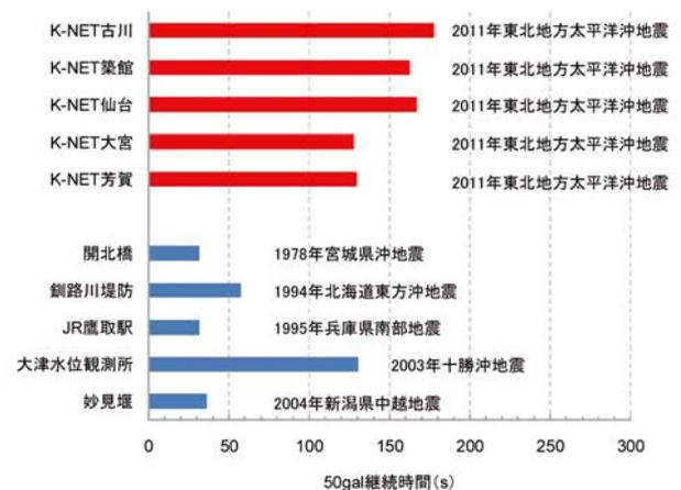
図-2 地震動の継続時間（既往地震との比較）
