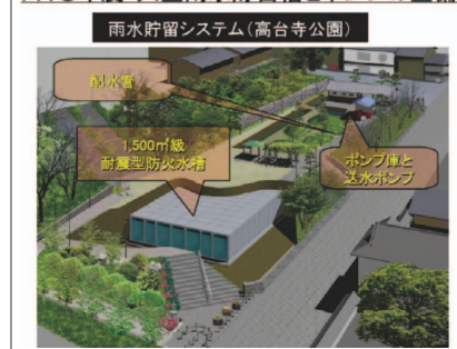
H18年度・大型雨水貯留槽とポンプの整備
