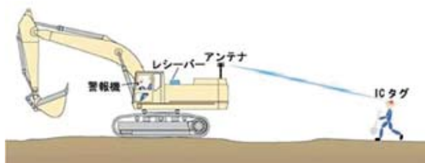
図-9 作業員接近警告システム（鹿島建設（株）HPより）
