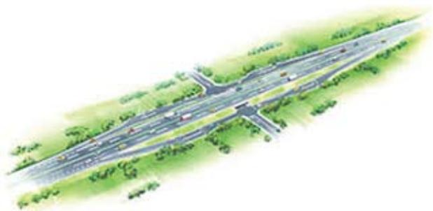
図-2 本線直結型スマート IC
