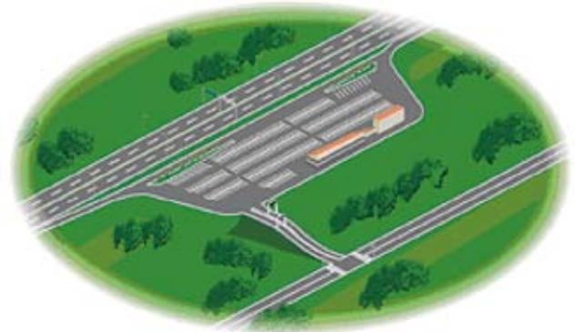
図-1 SA・PA 接続型スマート IC
