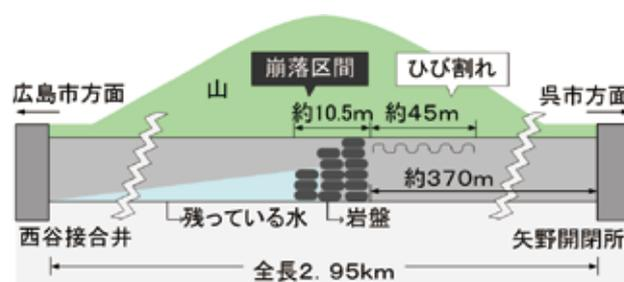
図-1 崩落事故のあった送水トンネルの断面図
