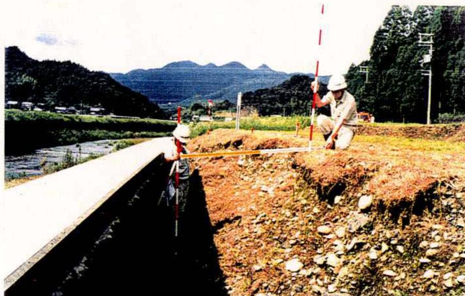
写真1.6 法肩工背後の土砂流出状況（近畿地方建設局）
