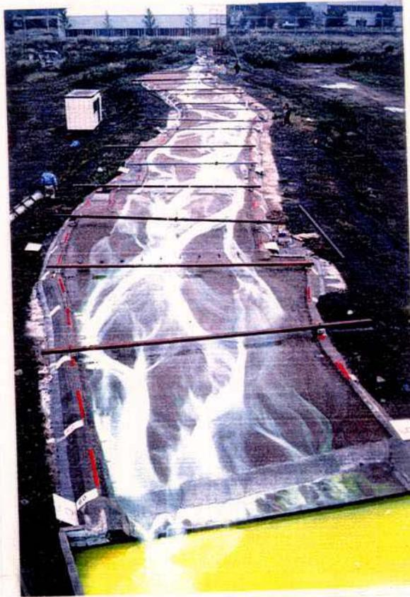
写真2.7 移動床模型実験（土木研究所）
