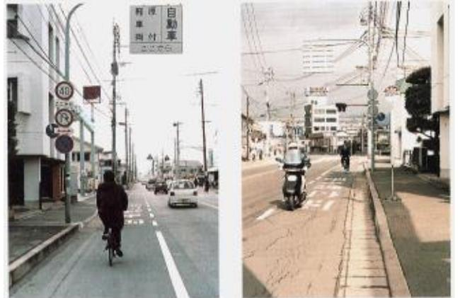
③ 広幅員・多車線道路の各構成要素の幅を少しずつ縮小して分離型の自転車走行空間を確保
