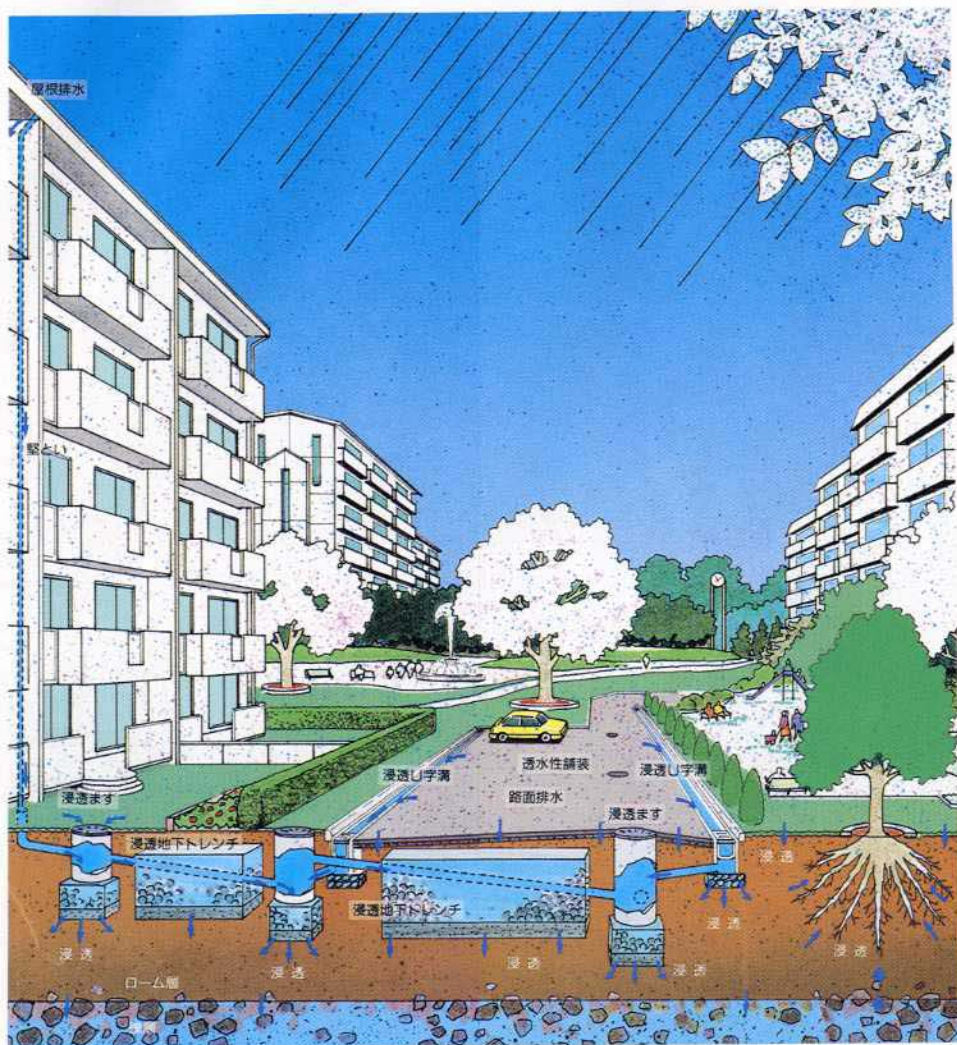
図 6 - 2 浸透型施設の概念図
