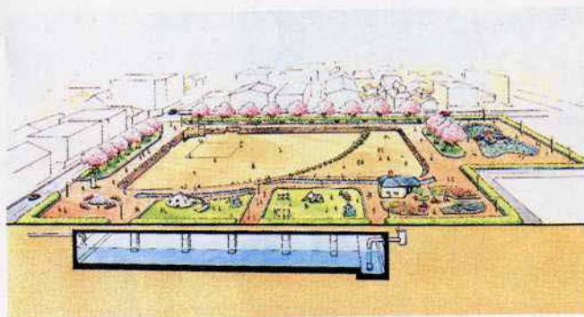
図 4-6 流域調節池の整備イメージ図
