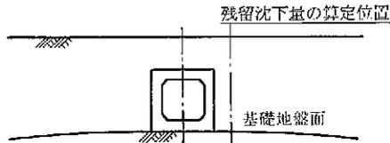
図 1-1-2 残留沈下量の算定位置
