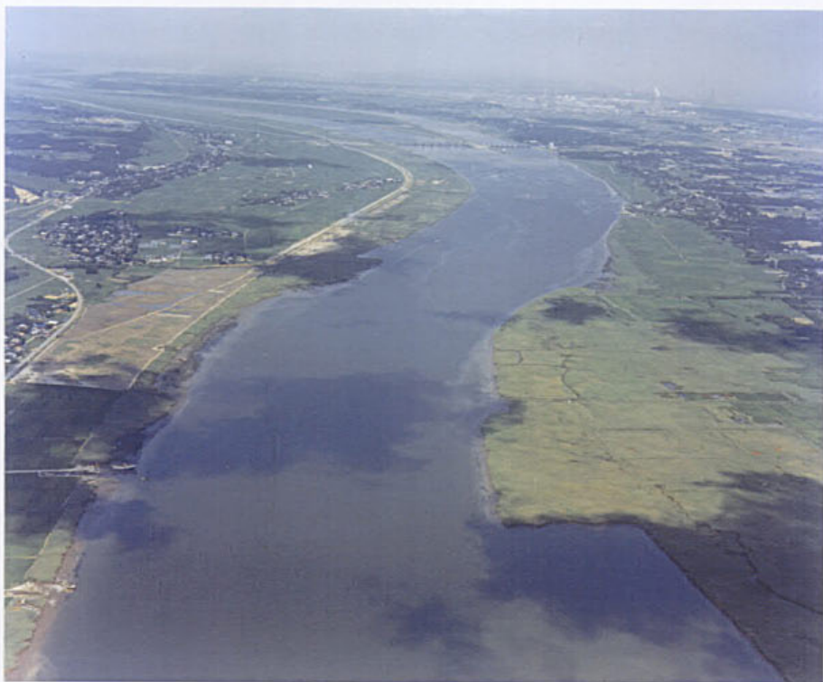
写真-5 セグメント3に分類される河道 ( d_R=0.15 mm) (利根川・11 km 付近, 関東地方建設局提供)
