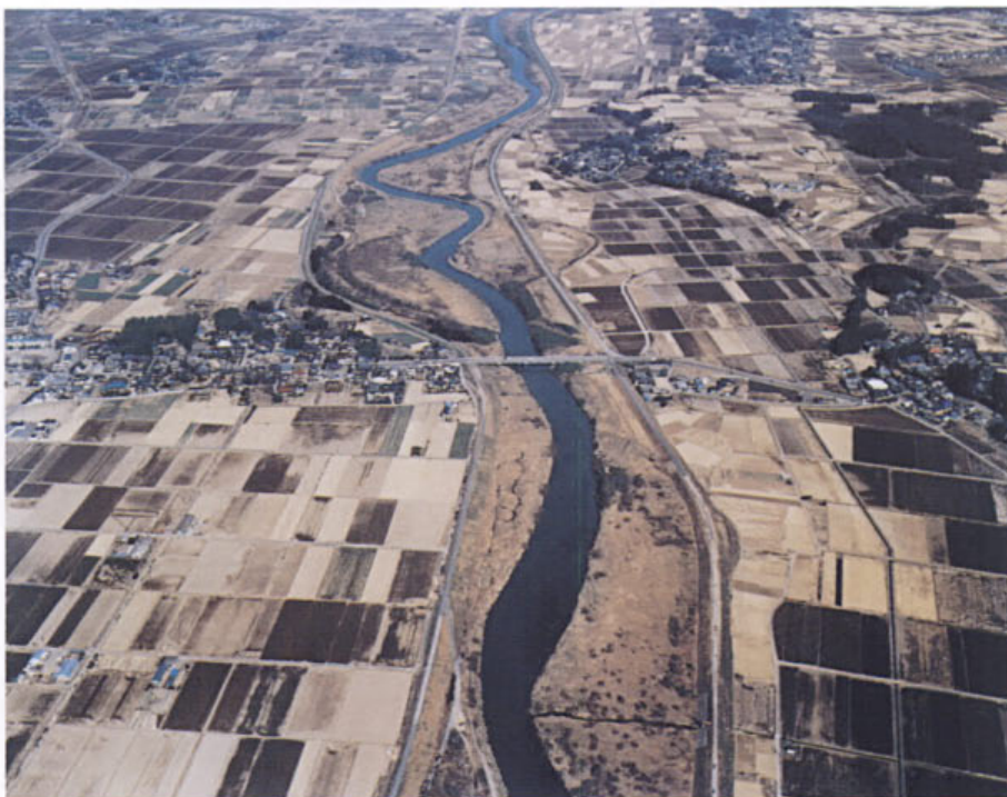
写真-3 セグメント 2-2 に分類される河道 ( d_R=0.3\sim 0.5 mm) (小貝川・44 km 付近, 関東地方建設局提供)
