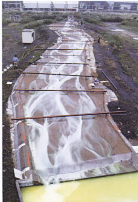
写真 4-2 移動床模型実験（土木研究所）
