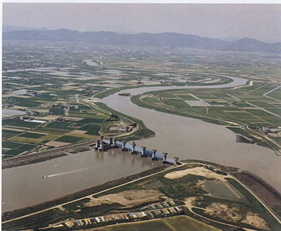
写真-6 セグメント3に分類される河道 ( d_R :シルト) (六角川・5~6 km 付近, 九州地方建設局提供)
