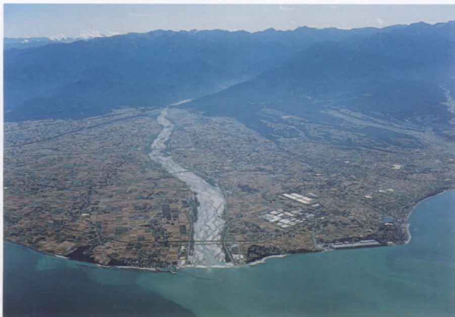
写真-1 セグメント1に分類される河道 (黒部川・0～11 km 付近, 北陸地方建設局提供)
