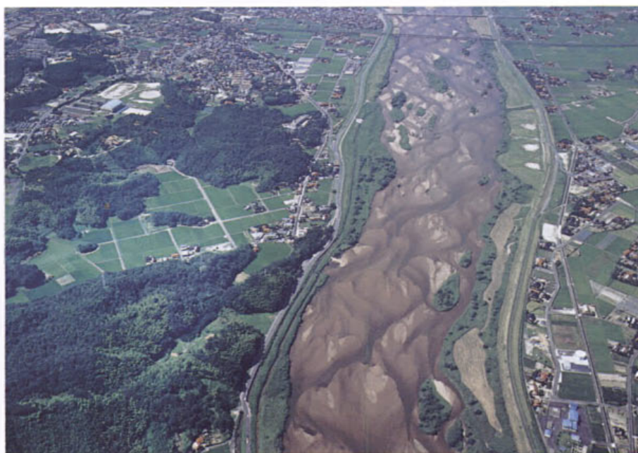
写真-4 セグメント 2-2 に分類される河道 ( d_R=2\sim 3 mm) (斐伊川・13.5 km 付近, 中国地方建設局提供)
