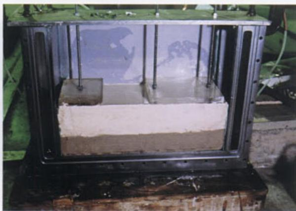
写真-3 地盤を整形後、載荷盤を設置し、予備圧密
