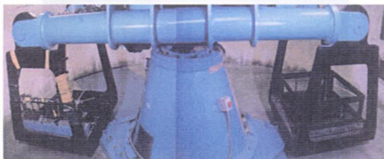
写真-1 実験に使用した遠心力載荷試験装置 (東京工業大学)
