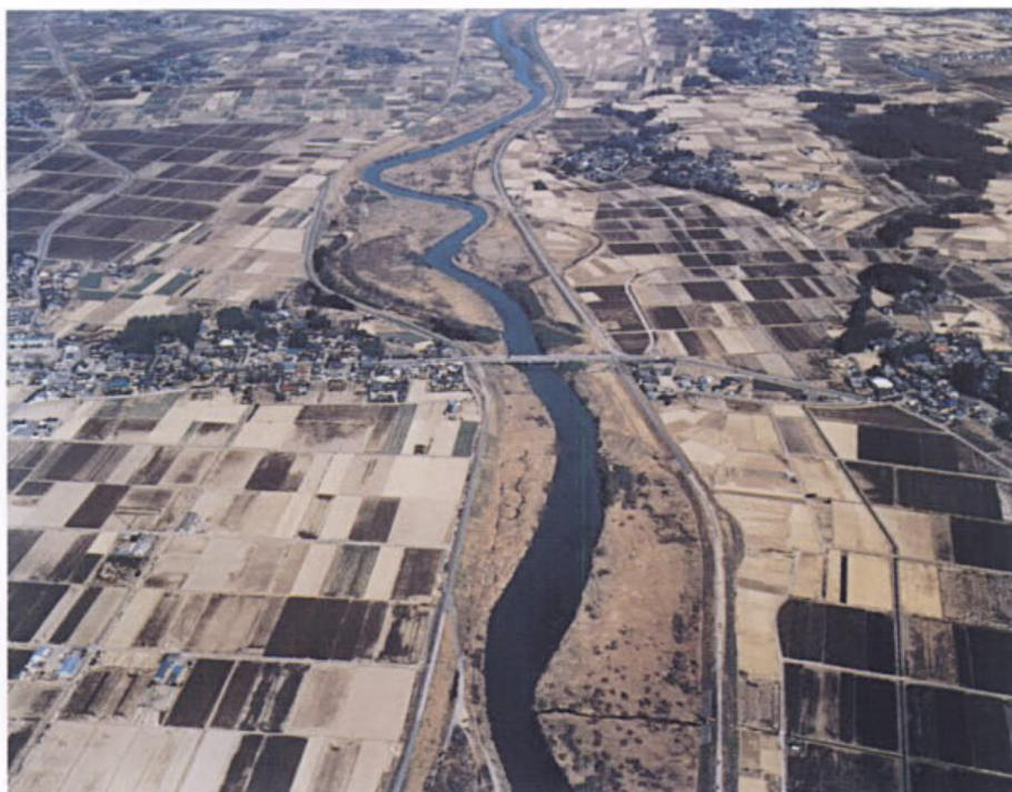
写真-3 セグメント 2-2 に分類される河道 ( $d_B=0.3\sim 0.5$  mm)
