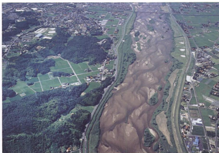
写真-4 セグメント 2-2 に分類される河道 ( $d_B=2\sim 3$  mm)
