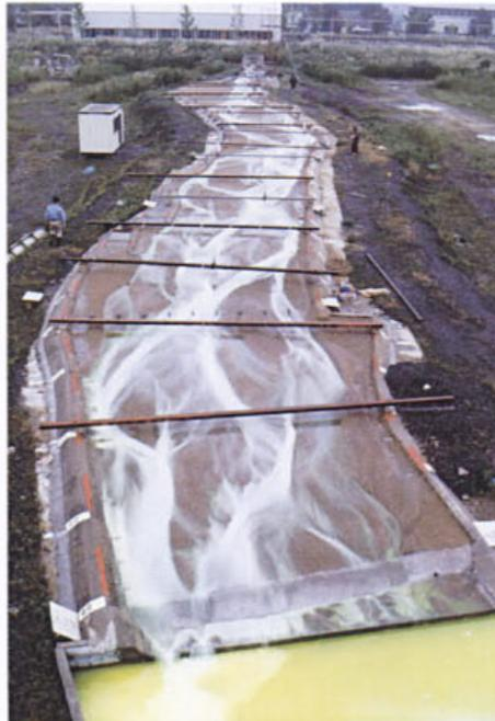
写真 4-2 移動床模型実験（土木研究所）
