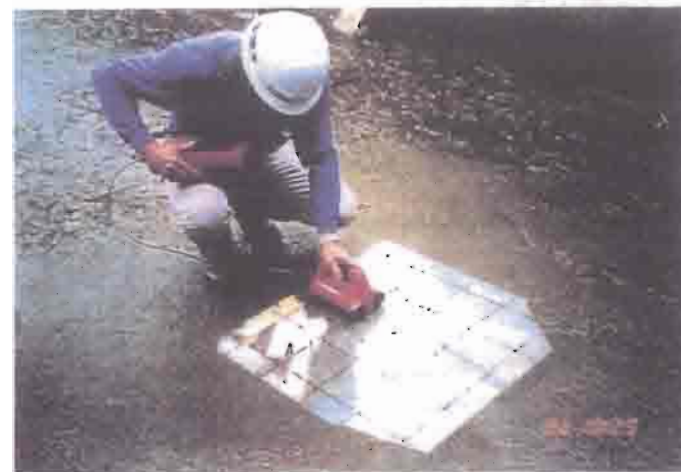
写真-参 4.4 鉄筋探査器による測定
