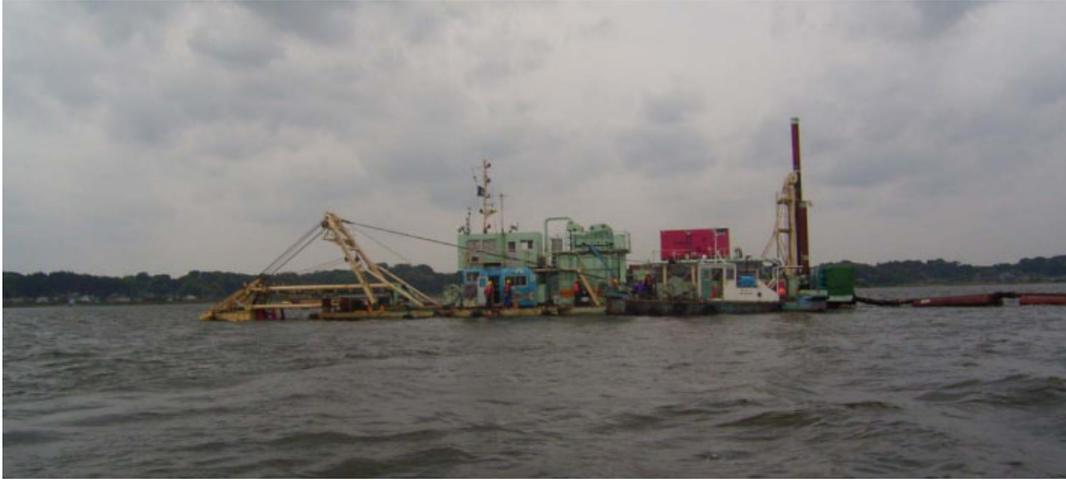
写真 7.4.1 ポンプ浚渫船作業状況
