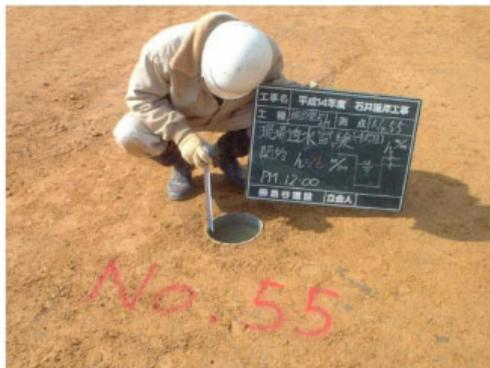
写真 7. 2. 13 ブランケットの透水試験の状況
