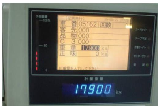
写真 7.5.4 トラックスケールを使用した積載重量の管理
