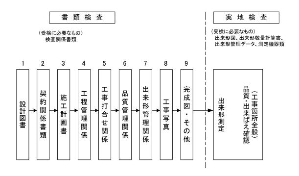
図 6.1.1 検査の順序の例
