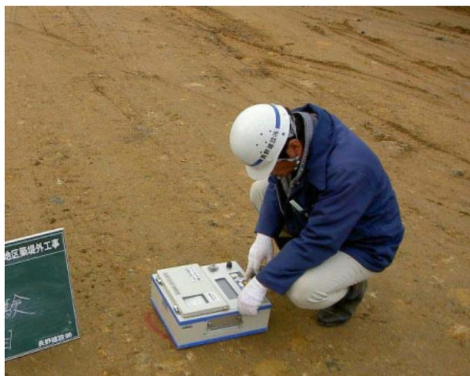
写真 5.3.2 現場密度試験実施状況 (RI 計器を用いた方法による)
