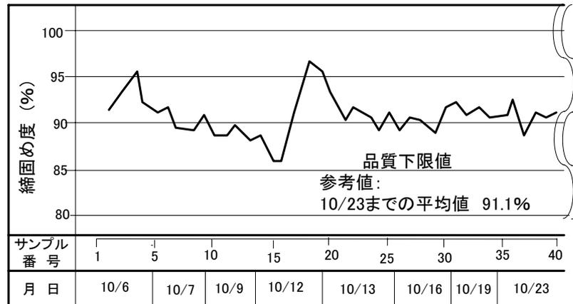
図 5.3.1 工程能力図の例
