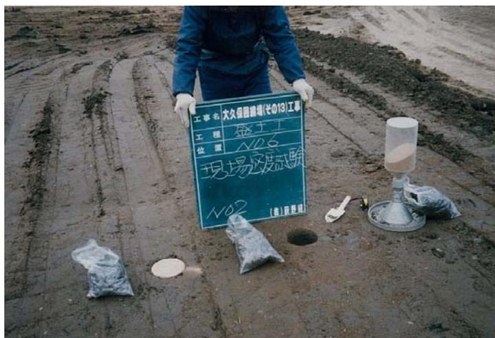
写真 5.3.4 現場密度試験実施状況（砂置換法による）
