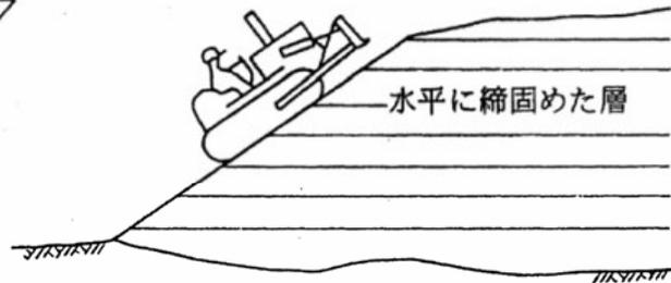
図 4.3.17 ブルドーザによる締固め
