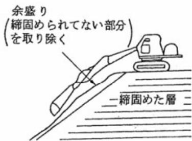
図 4.3.18 油圧式ショベルによる整形
