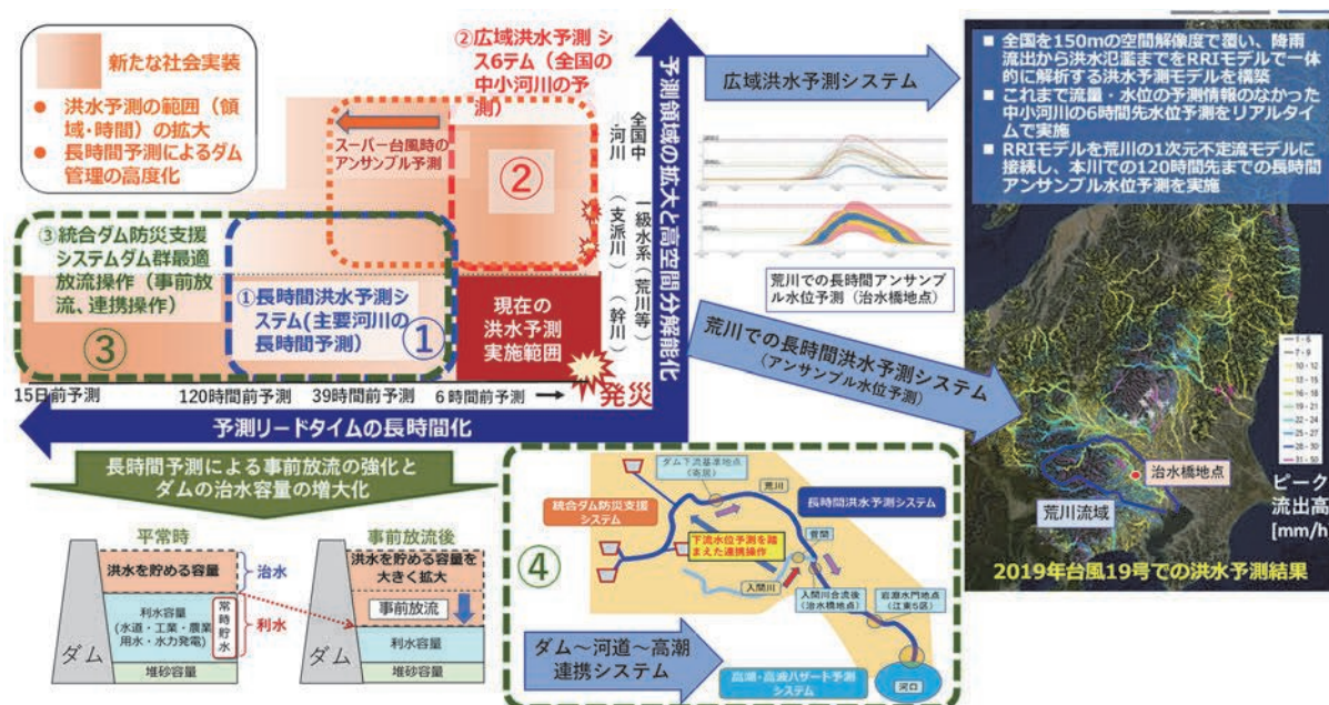
図 4.1-1 長時間/広域洪水予測システム・統合ダム防災支援システムの開発
