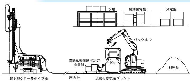
施工機械と流動化砂製造プラント
