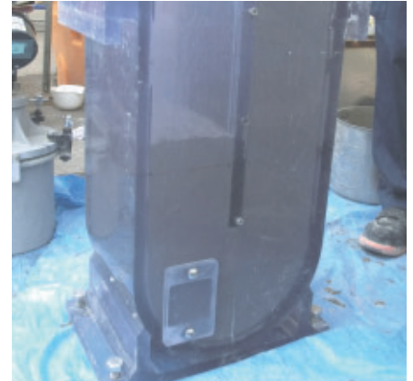
圧送試験(U型充てん高さ)状況
