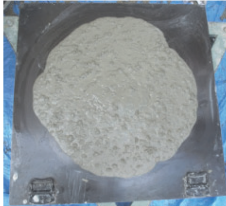
圧送試験(スランプフロー)状況
