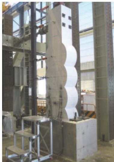
曲げ性能試験状況
