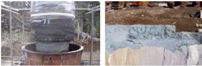
拡頭型HYSC杭（拡頭タイプSS）掘り起し試験
