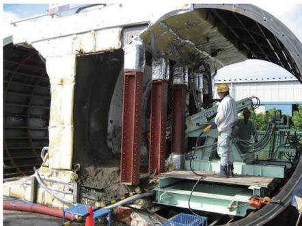
実物大の掘削実験状況
