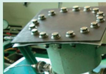
止水性室内確認試験 (0.5MPaまで加圧)
