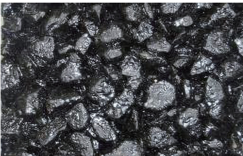
排水性・低騒音舗装 (骨材最大粒径13mm)
