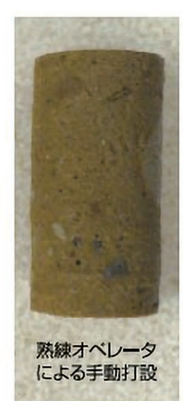
手動運転とGeoPilot-AutoPileの改良品質の比較
