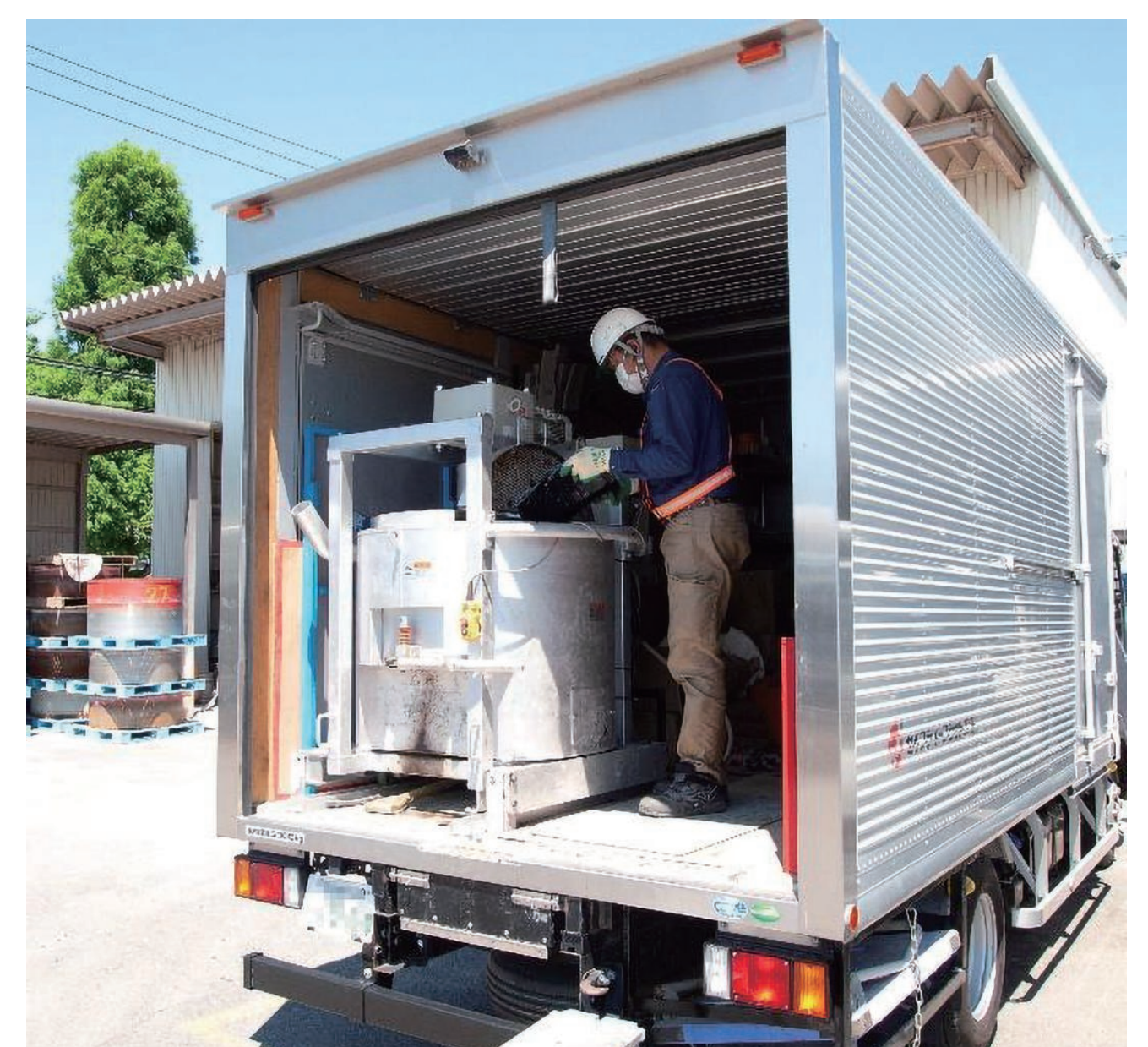
「ERミキサー」を積載し材料の運搬・製造機能をパッケージ化した専用プラント車
