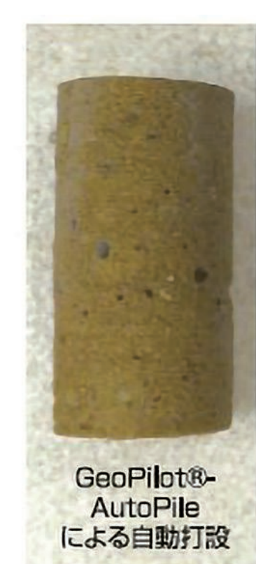
手動運転とGeoPilot-AutoPileの改良品質の比較
