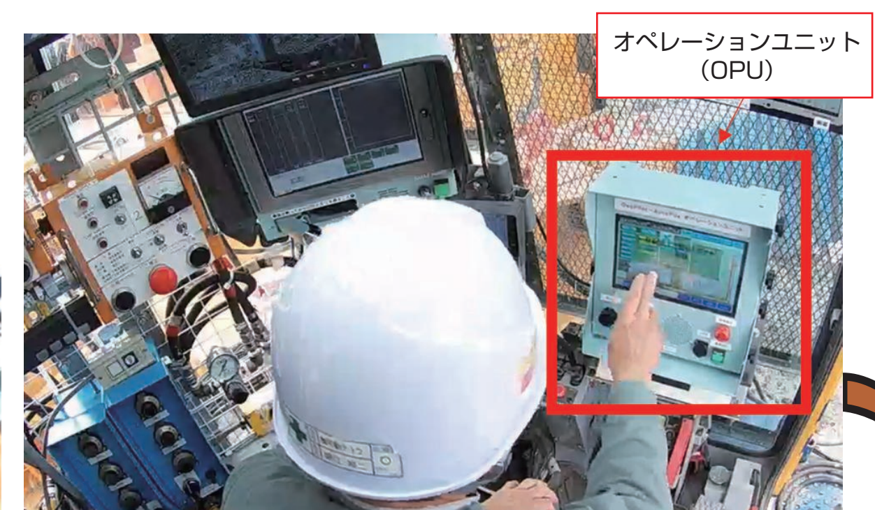
自動打設システムによってオペレーションユニットの画面をタッチするのみ
