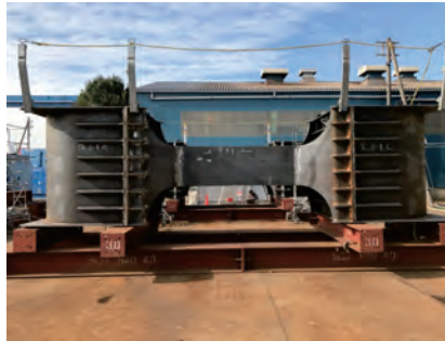
写真-1 深梁本体
