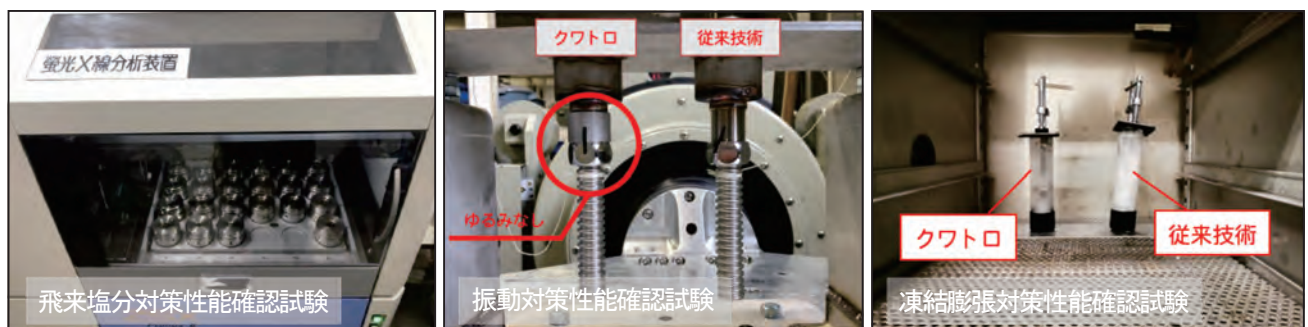
写真－１ 性能確認試験（飛来塩分対策・振動対策・凍結膨張対策）
