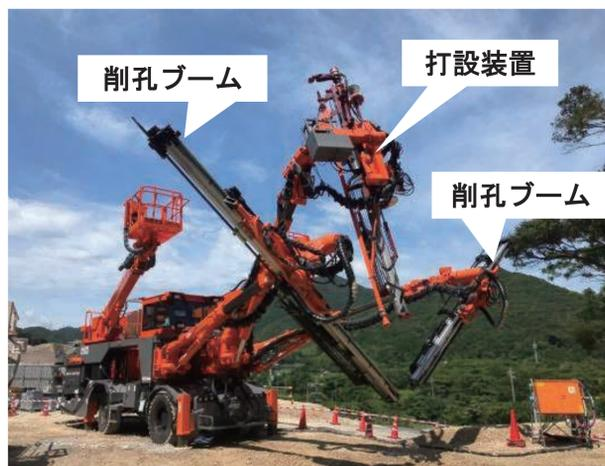
左右：削孔ブーム 中央：打設装置
