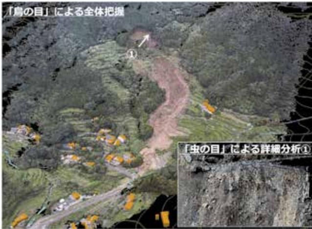
図一 地すべり災害対応のBIM/CIMモデル
