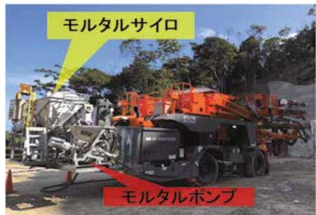
図-4 モルタル供給装置を一体化
