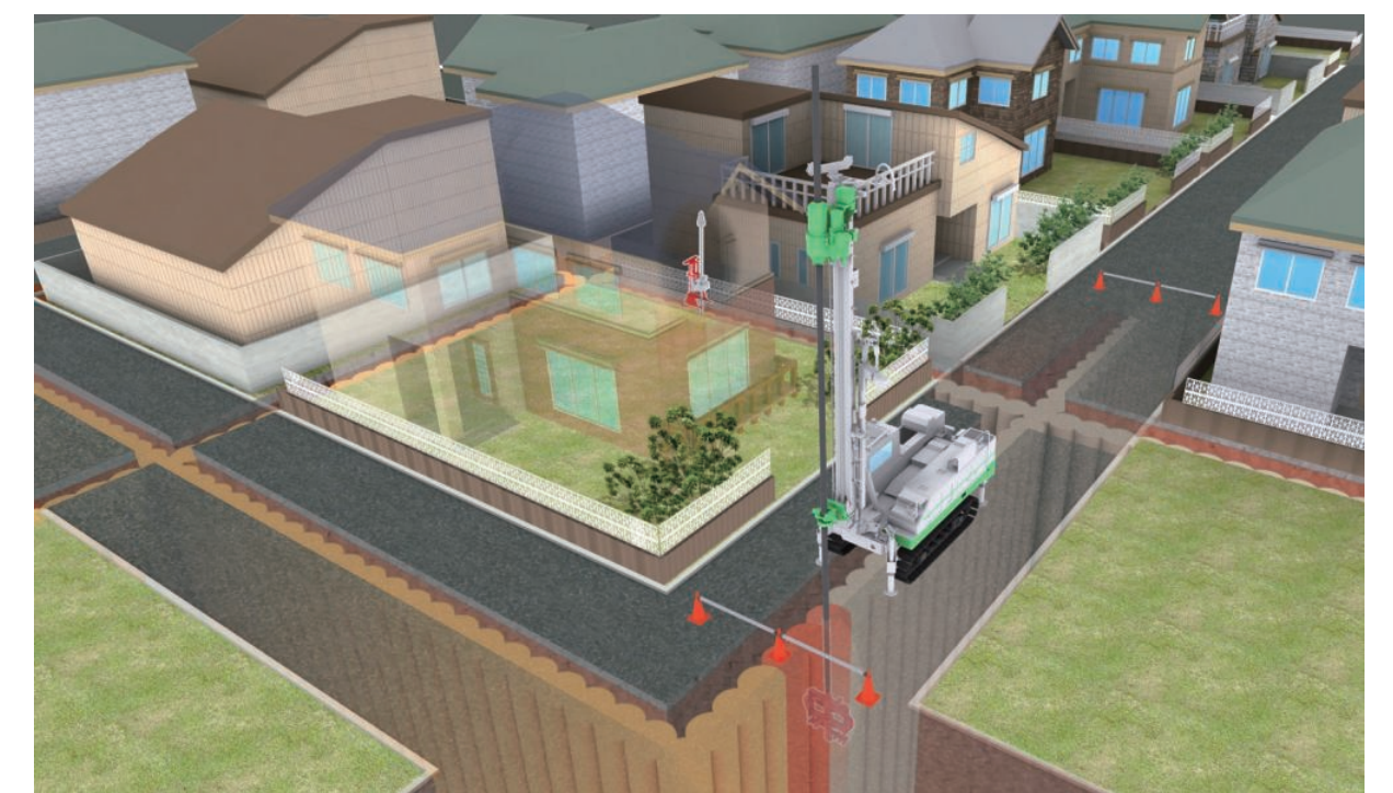
宅地境界を改良壁で囲む新しい工法
