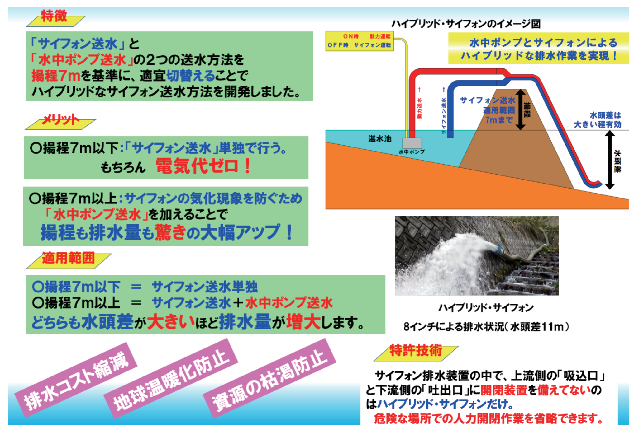
図-2 ハイブリッド・サイフォンの二通りの送水方法とその特徴
