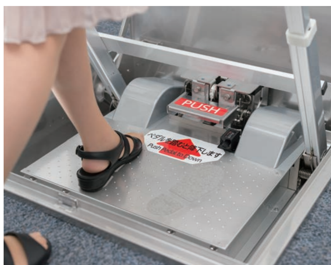
写真-3 昇降架台と降下の様子
