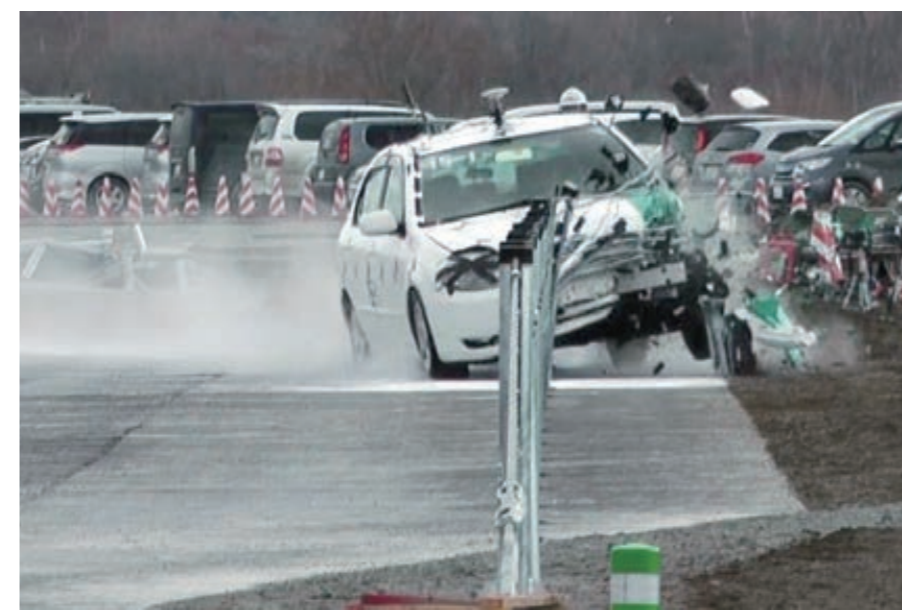
▲乗用車衝突試験（100km/h, 20 度）
