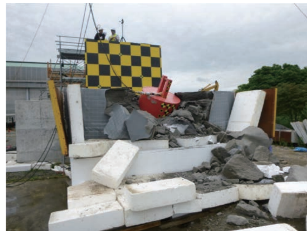
(左上) 写真-2 室内要素実験 (上) 写真-3 落石防護擁壁模型実験 (左) 写真-4 実規模実験
