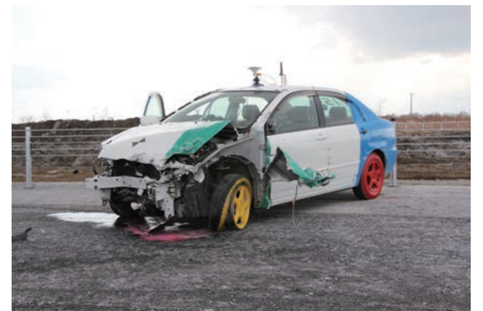
▲衝突後の乗用車損傷状況
