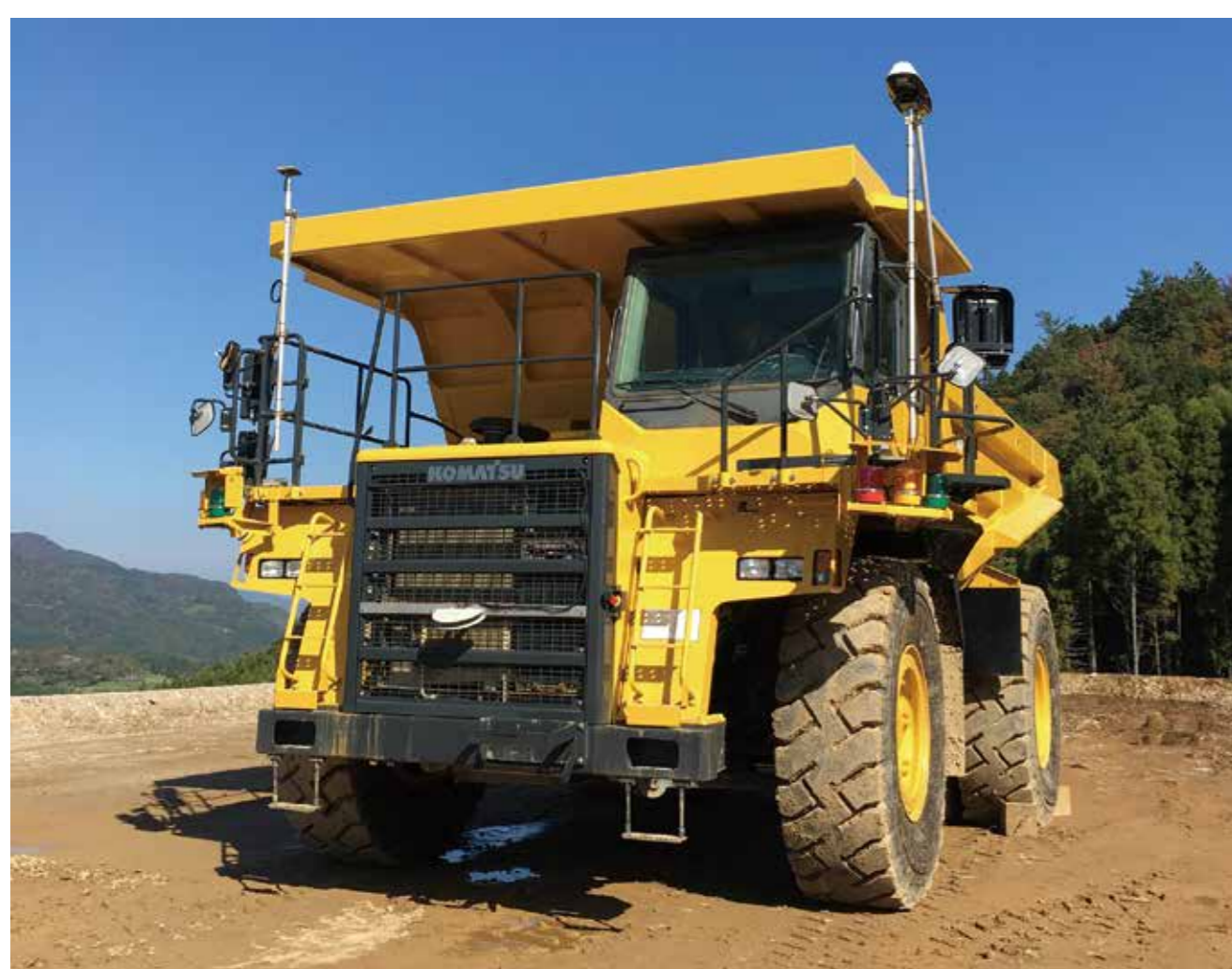
55t 積級の汎用ダンプトラックに GPS 機器・制御 PC 等を搭載
