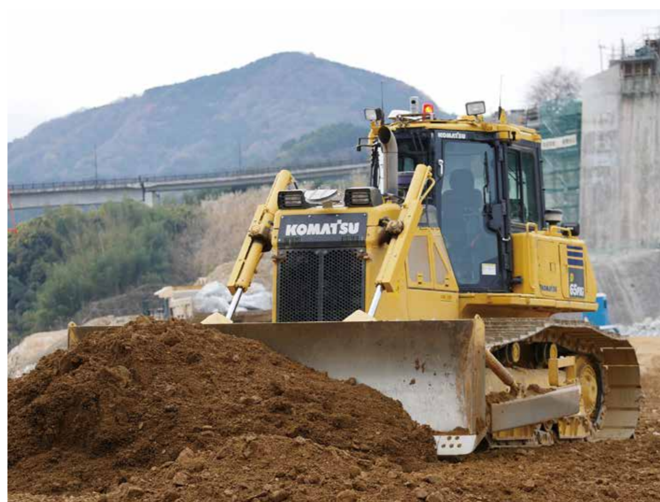
コマツ製 ICT ブルドーザに自動化機器・装置等を搭載
