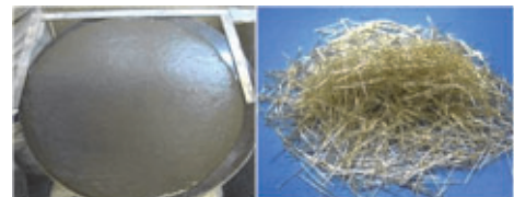
左：超高強度モルタル（圧縮強度 200\text{N/mm}^2 ） 右：超高強度鋼繊維（引張強度 2,000\text{N/mm}^2 ）
