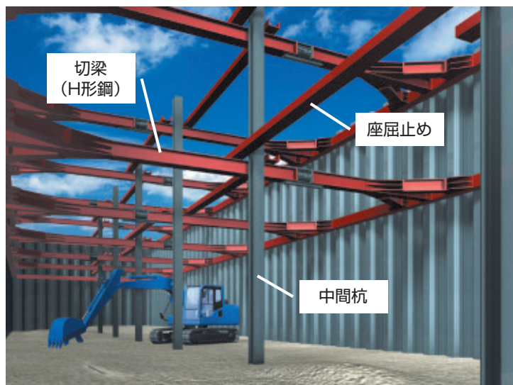
図-1 従来型土留め工
