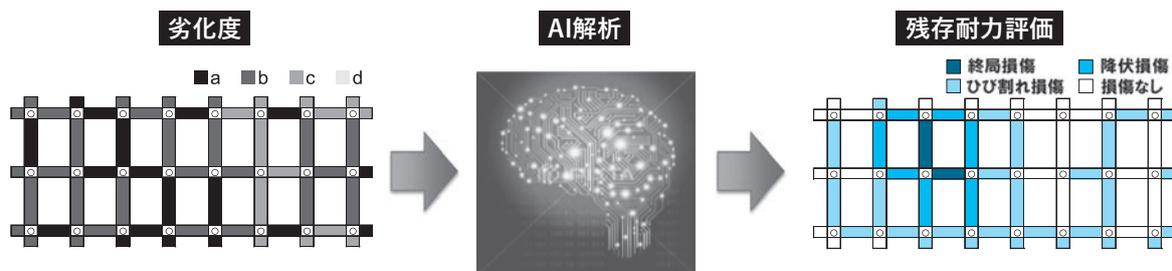
図－4 AIを用いた栈橋の残存耐力評価
