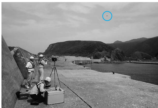
写真-3 ドローンによる空中写真測量
